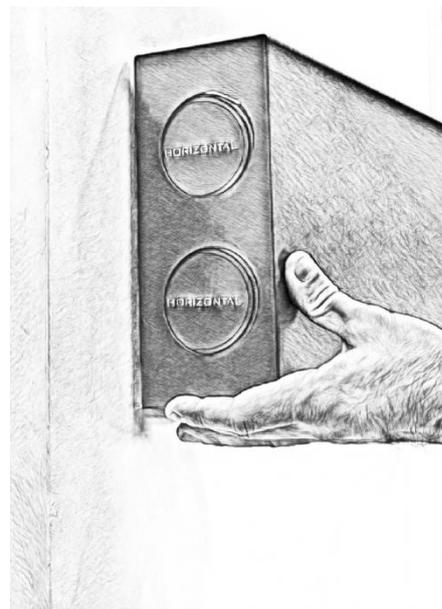
1. Setzen Sie das Gehäuse auf die Seite mit den Durchgangsbuchsen und schieben Sie es, um die Federn zu komprimieren.
